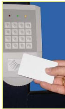
Berechtigungen können elektronisch codierte Ausweiskarten oder Schlüssel, Tastaturcodes (PIN) oder auch biometrische Merkmale sein. Welches System im Einzelfall empfehlenswert ist, hängt von den speziellen örtlichen Gegebenheiten und dem jeweiligen Sicherheitsbedürfnis ab.
